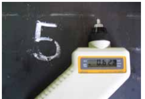
テーブル振動機の振幅測定 1-0.59/2-0.51/3-0.64/4-0.61/5-0.62mm
