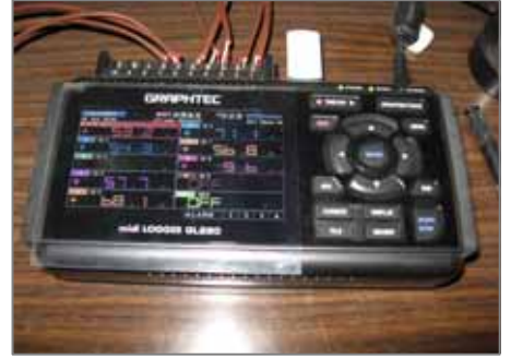
データロガー/コンクリート等温度管理 グラフテック GL220
